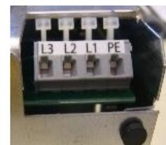
Vous devez utiliser un petit tournevis pour appuyer sur les leviers respectifs L3, L2, L1 et PE du bornier et ainsi pouvoir réaliser toutes les connexions. Nous suggérons la mise en place d'embouts aux extrémités de chacun des conducteurs.
